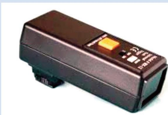
**Infrarrojos.** Estos disparadores se ponen en la zapata de nuestra cámara o en la zapata del flash, emiten un haz de luz infrarroja (IR) que sirve de comunicación con el o los flashes. Muchos flashes ya llevan incorporado el receptor de IR. Tienen las ventajas de que no hay cables, son más cómodos, se pueden asignar grupos a los flashes, modificar la potencia de cada grupo en el emisor, en condiciones ideales tienen buen alcance. Como des-
